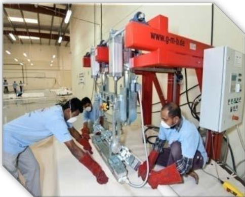
Tensile Membrane Fabrication
